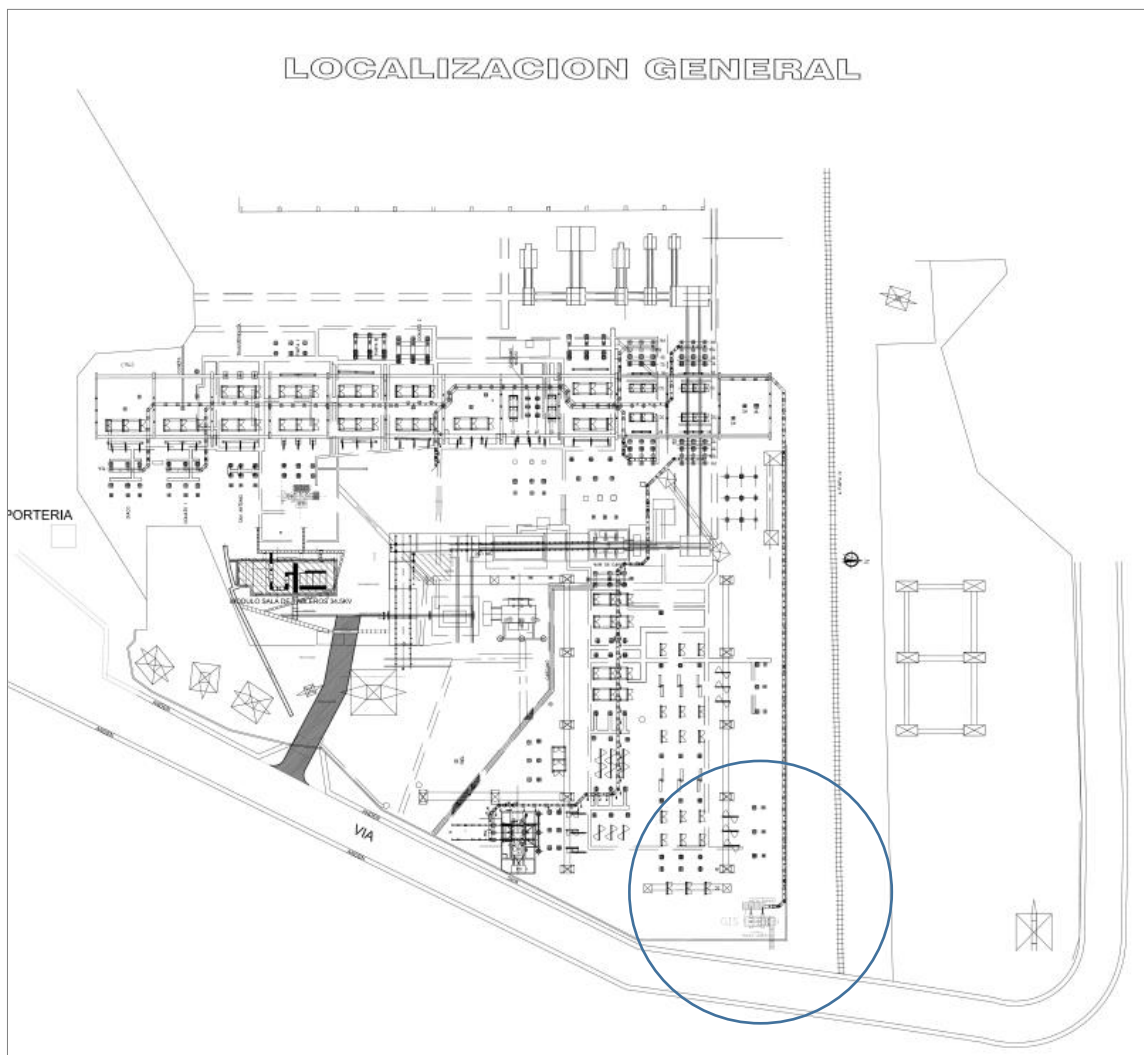
Figura 3-24 Localización general GIS en la subestación Paipa Fuente: EBSA
