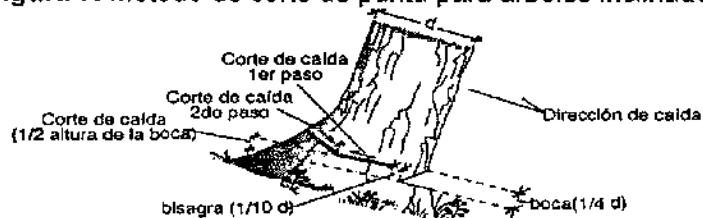
Figura 7. Método de corte de punta para árboles inclinados
