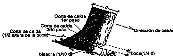
Figura 1. Método de corte de punta para árboles inclinados
