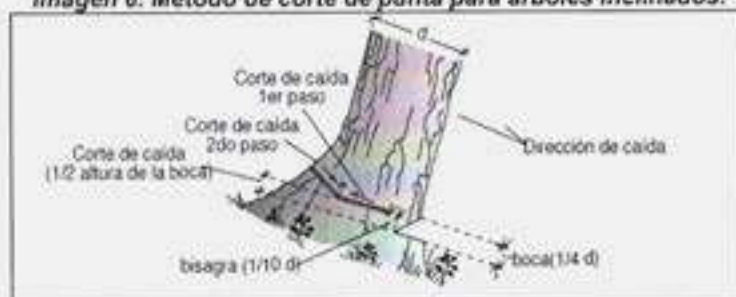
Imagen 6. Método de corte de punta para árboles inclinados.
