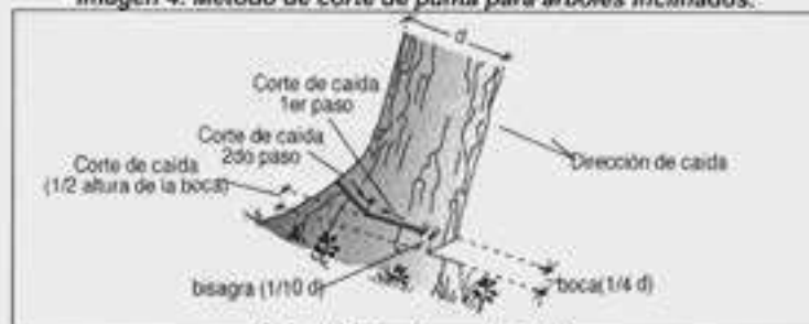
Imagen 4. Método de corte de punta para árboles inclinados.
