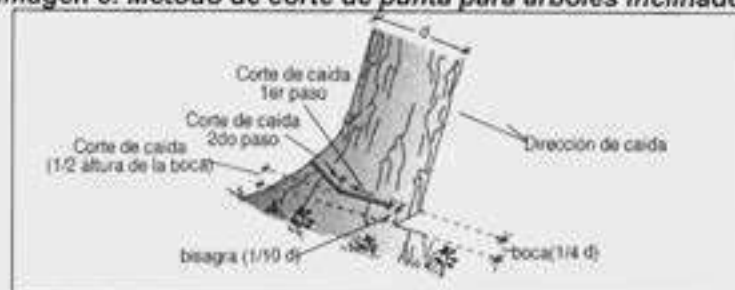
Imagen 5. Método de corte de punta para árboles inclinados.
