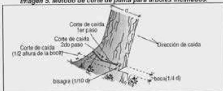
Imagen 5. Método de corte de punta para árboles inclinados.
