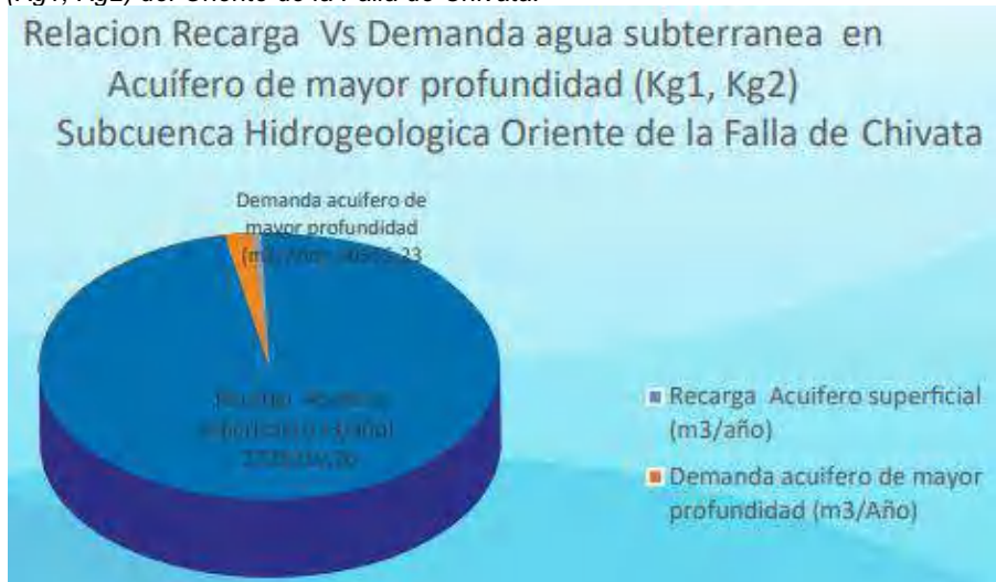
Figura 43. Relación de la Recarga Total Vs. la Demanda Total de agua Subterránea en acuífero de mayor profundidad (Kg1, Kg2) del Oriente de la Falla de Chivatá.
